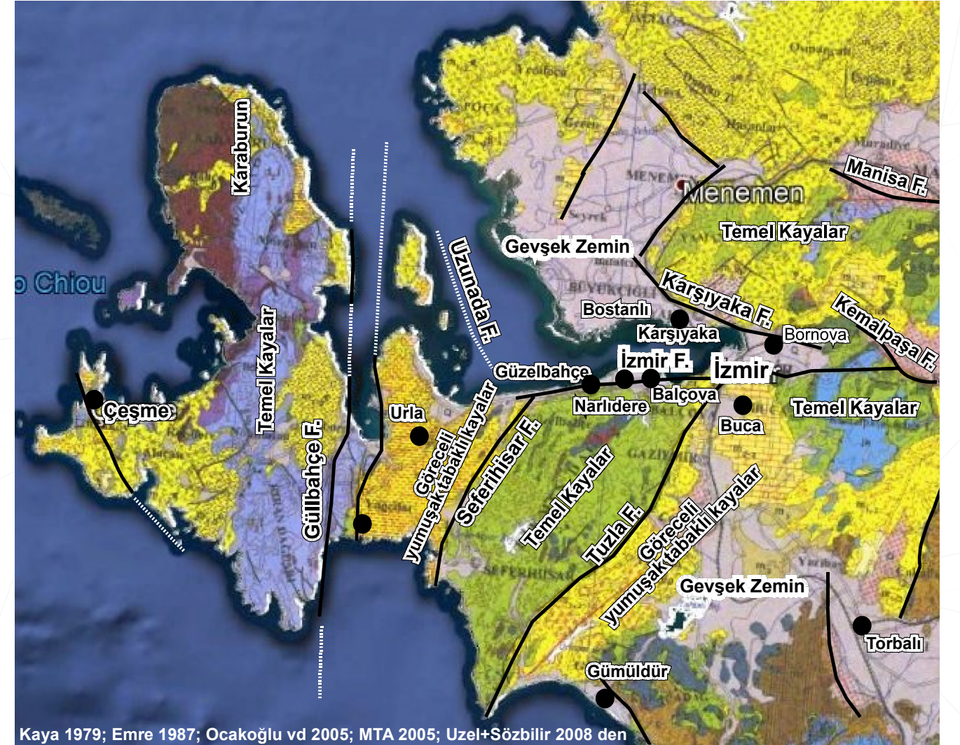
Şekil 1. İzmir Merkez alanını etkileyen yeryüzeyi kırıkları (faylar) ve gevşek zemin /kaya zemin
