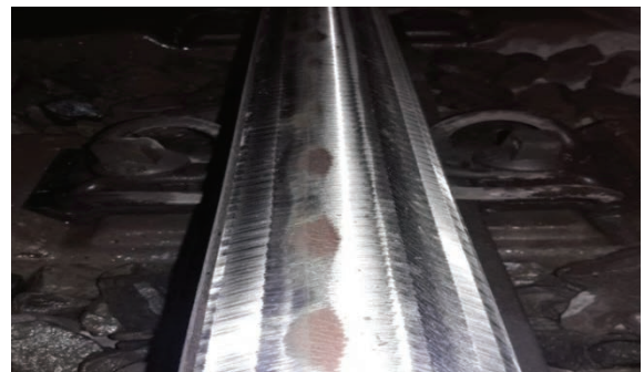
Taşlama Sonrası Ray Kontrolü
