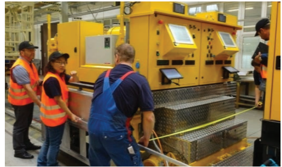
Taşlama Makinesinin Fabrika İmalat Kontrolü
