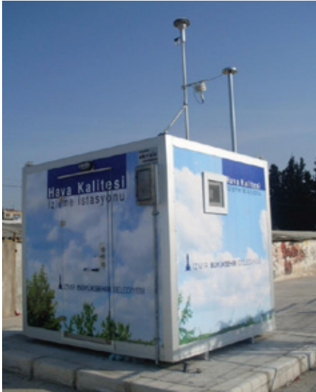
Hava Kalitesi Ölçüm İstasyonu
